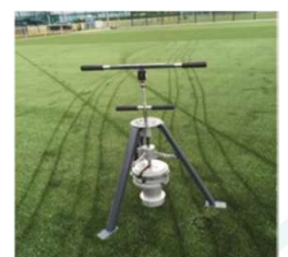
Monitoring zur Bestimmung des Spielverhaltens (Rückschlüsse auf -> Faseralterung und Recyclingart)
