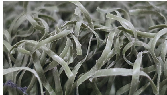
Filamentgarn R4 nach Reinigung
