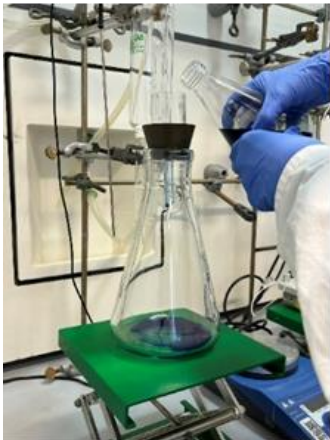
Filtration der Testlösung
