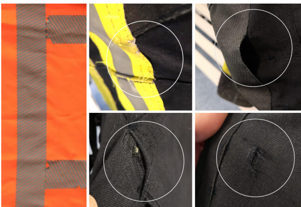
Typische Beschädigungsarten der Schutzkleidung mit Funktionsverlust
