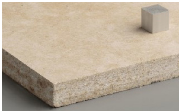
In Gipsfaserplatten sollen Alttextilien eingearbeitet werden.
