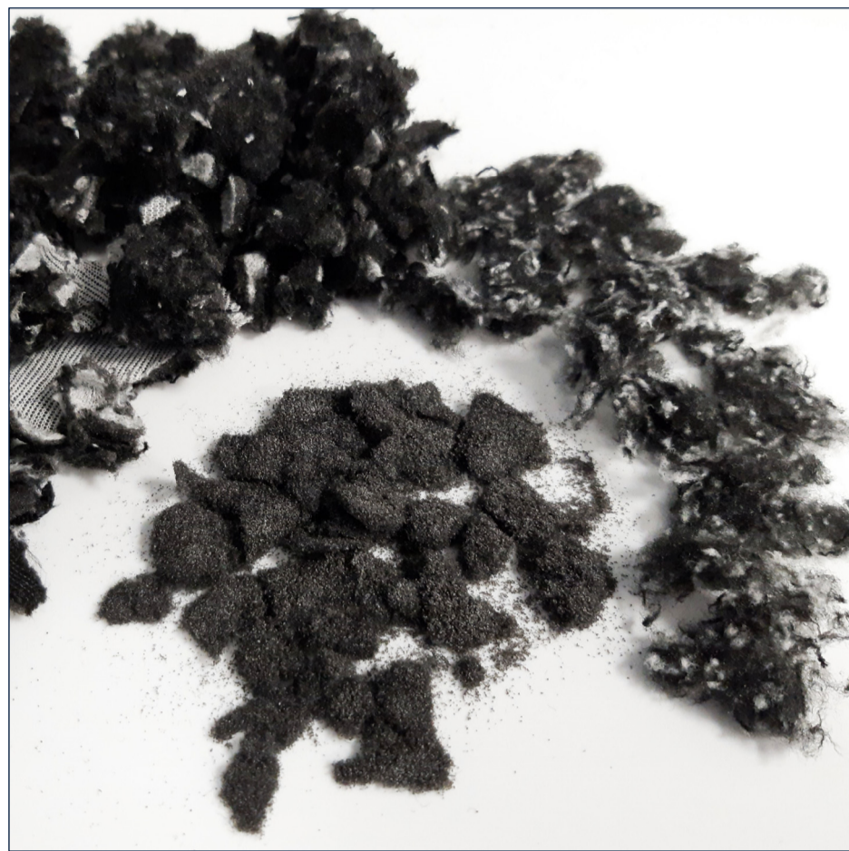
Bild 1: PES-Textil mit PU-Schaum in verschiedenen Verarbeitungsstufen (gemahlen, getrennt)
