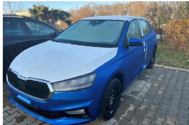
Abdeckmaterialien aus Polypropylen (PP) an Fahrzeugen.
