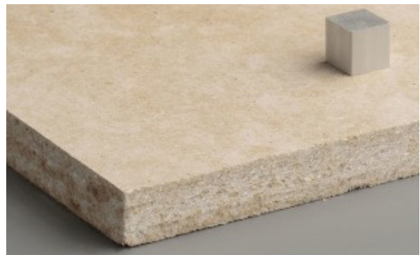
In Gipsfaserplatten sollen Alttextilien eingearbeitet werden.
