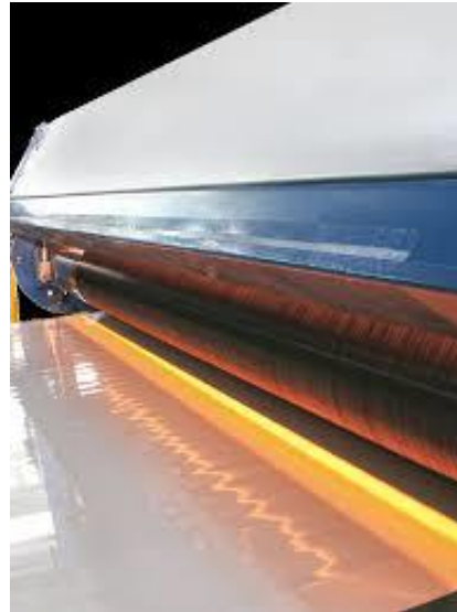
Prepregherstellung: Impregnierung der Fasern mit dem entwickelten Harz
