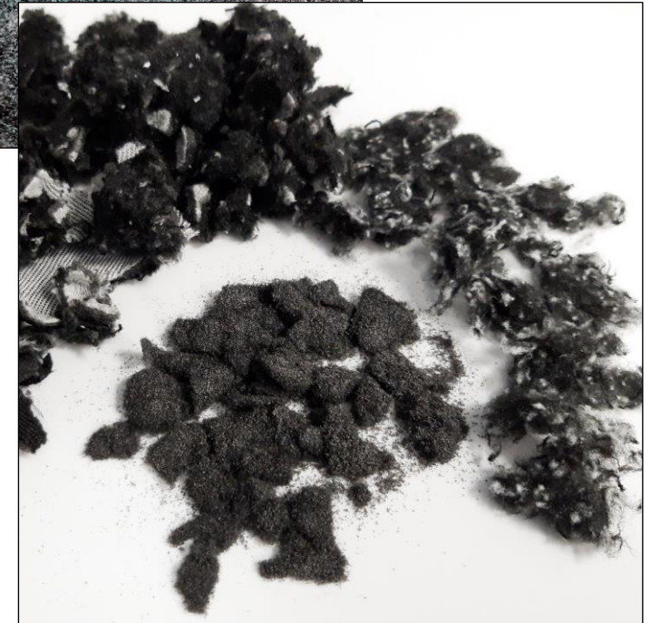
Bild: Textile Polyester/Polyurethan-Mischabfälle in verschiedenen Aufbereitungsstufen
